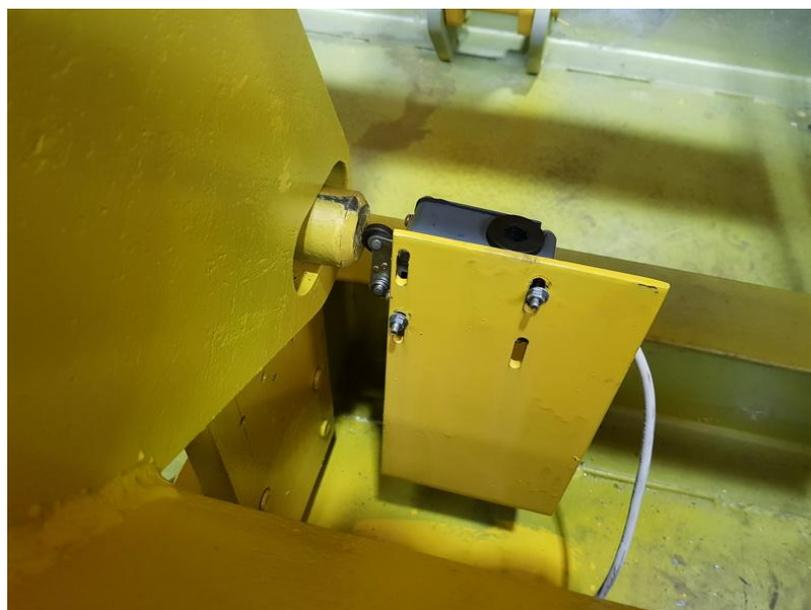
Регулировка фиксаторов в выдвинутом положении ВК2-ВК4
