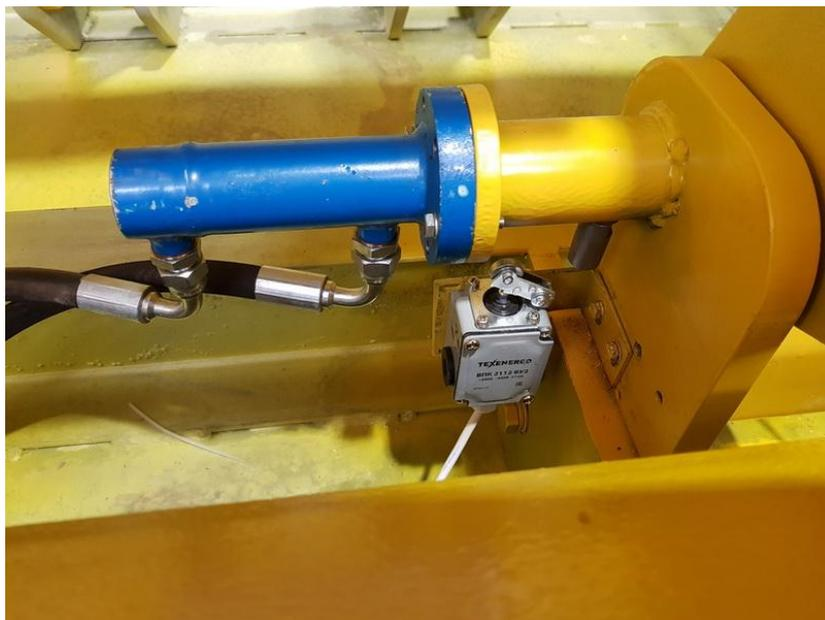
Регулировка фиксаторов в задвинутом положении ВК5-ВК6
