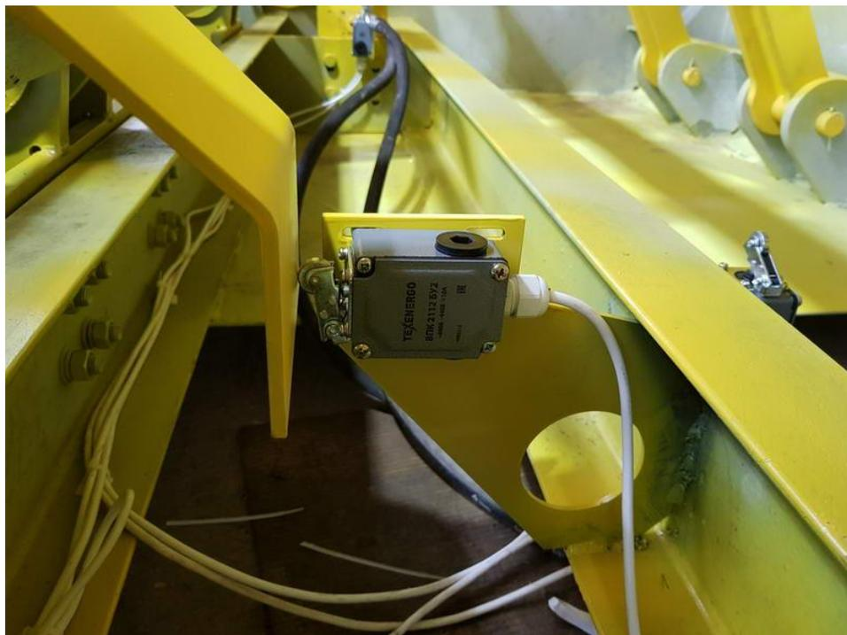
Концевой выключатель верхнего положения гидроцилиндра ВК1
