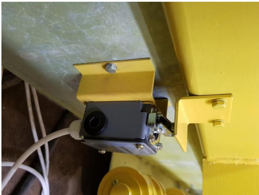
Концевой выключатель нижнего положения гидроцилиндра ВК3
